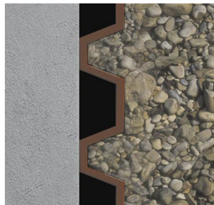
Standardne bobičave folije zapuše se zemljom, ne postoji drenaža.
