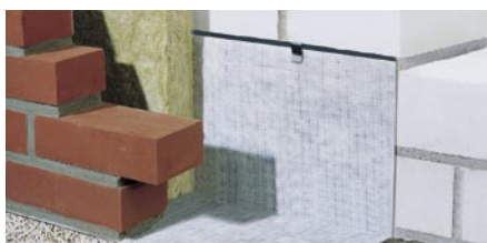
DELTA®-PROTEKT je univerzalna „L“-brana u građevinskim konstrukcijama.
